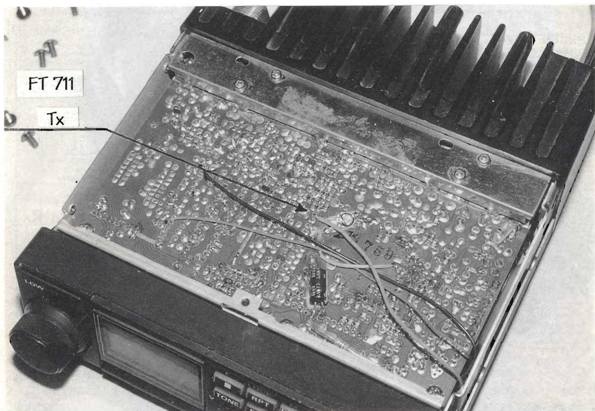
Yaesu FT711. Filo verde porta il segnale Tx prima del trimmer.
