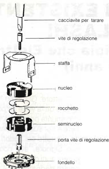
Nucleo ad olla con assieme di montaggio e regolazione completo.
